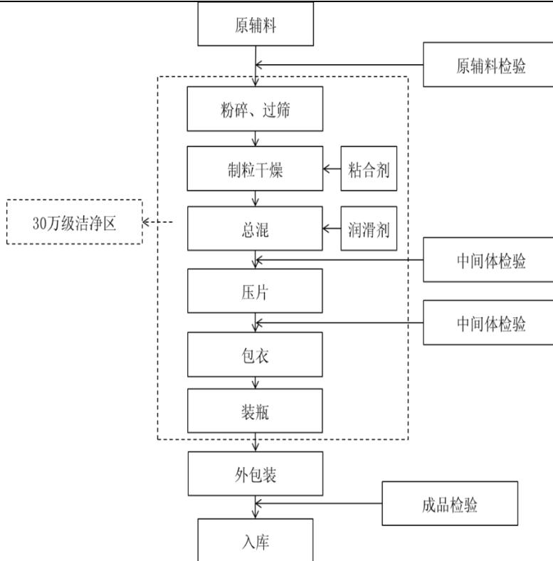
工艺流程说明: 本工艺过程分为粉碎, 制粒干燥、总混、压片、包衣、装瓶、外包装等到成品, 经检验后入库。
