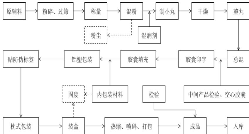
工艺流程说明：原料药及辅料进入车间后，经粉碎、过筛（60 目或 80 目）、称量、混粉后，经包衣制丸机制小丸并经真空干燥后，混合成批量、经检验合格后、全自动胶囊填充机进行胶囊填充（空心胶囊填充前先经印字机印字），经铝塑泡罩包装机包装，再经外包装（选片贴标、枕式包装、装盒、热缩、喷码、打包）到成品，经检验后入库。
