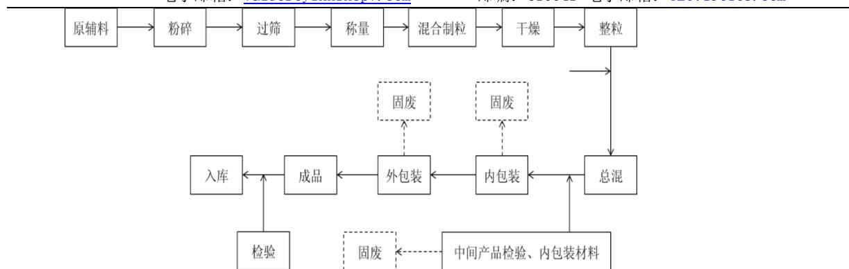
工艺流程说明: 原料药及辅料进入车间后经粉碎、过筛、称量、混粉、制粒、干燥后、整粒、混合成批量, 经检验合格后, 经自动颗粒包装机内包装, 再经外包装(装盒、热缩、喷码、打包)到成品, 经检验后入库。
