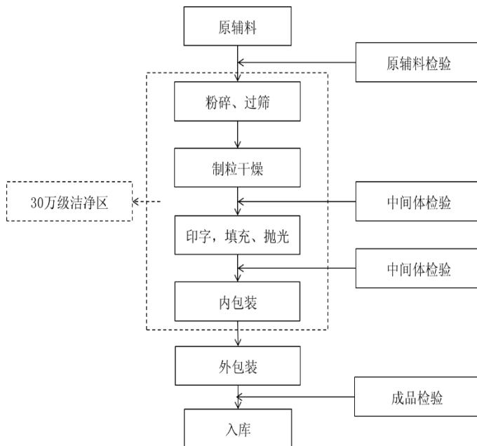
工艺流程说明: 本工艺过程分为粉碎过筛、制粒干燥、印字填充抛光、装瓶或铝塑包装、外包装等到成品, 经检验后入库。
